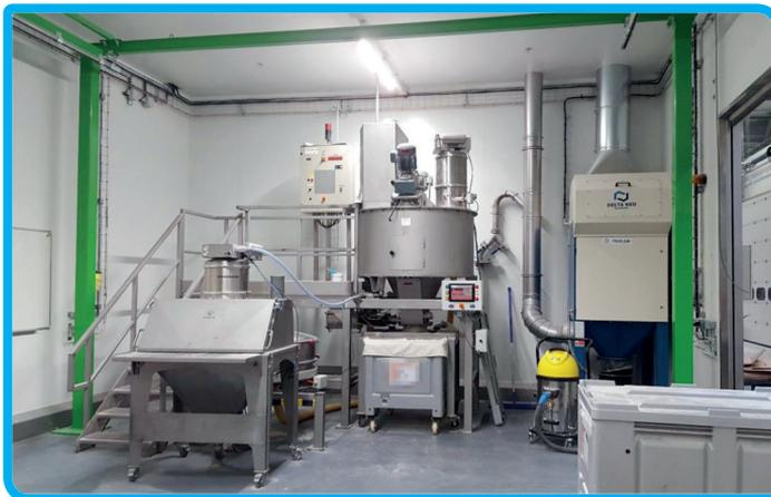
*Transfert pneumatique. Permet de transférer n'importe quel ingrédient de manière automatique. Nécessite tout de même de vider l'ingrédient (sac, carton etc...) dans une trémie. Diminution de la manutention.*
