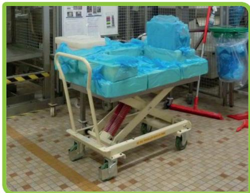
*Mise en place d'une table à niveau réglable pour aider l'opérateur dans les efforts de tirer-pousser.*
